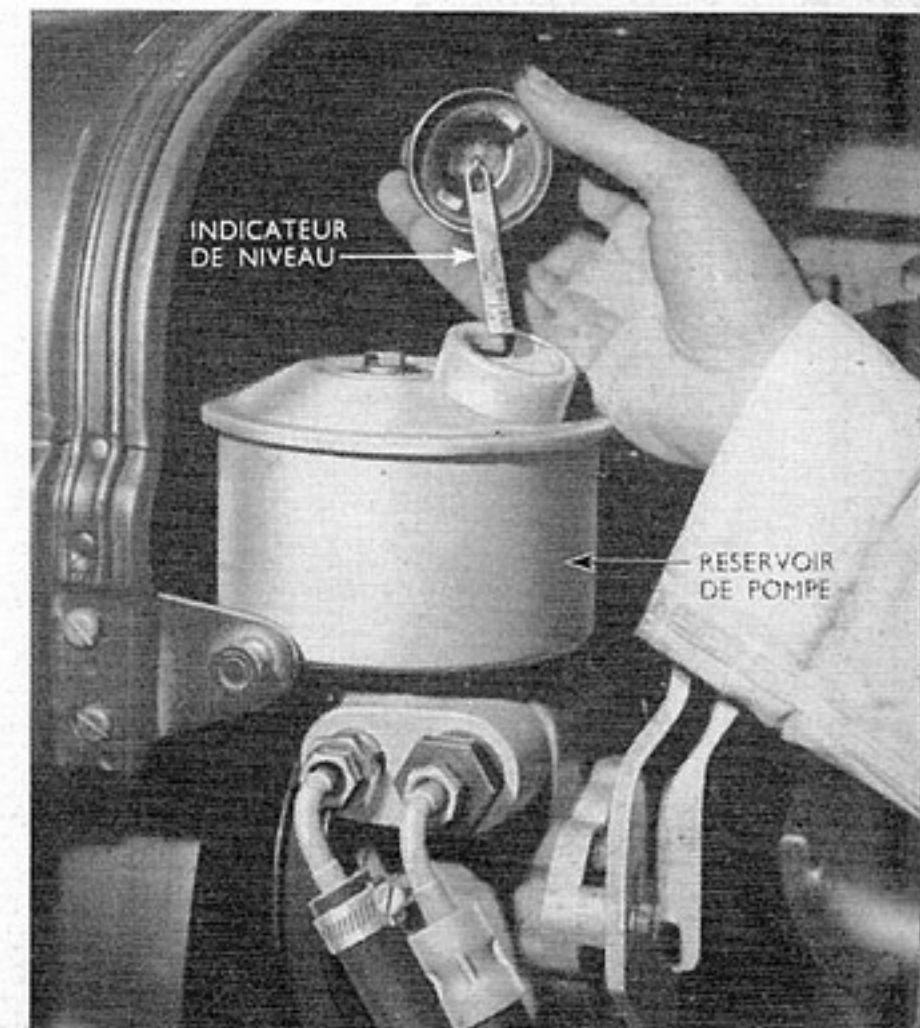
Fig. 48 Vérification du Niveau d'huile du Réservoir de la Pompe
