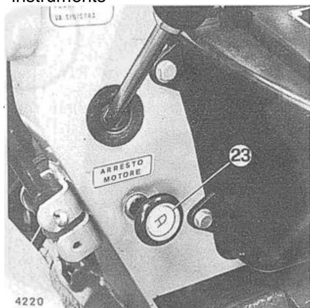
Fig 3 Arrêt du moteur pour les mod. 928, 930, 932 et 933.
