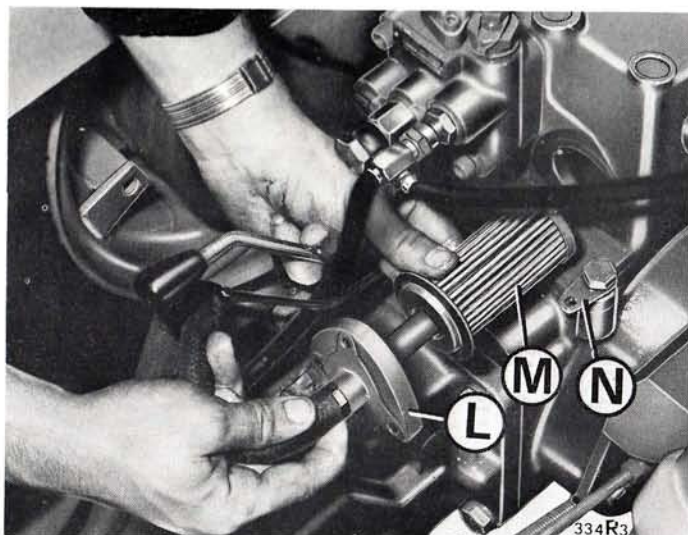
Fig. 32 - Nettoyage du filtre d'huile hydraulique
