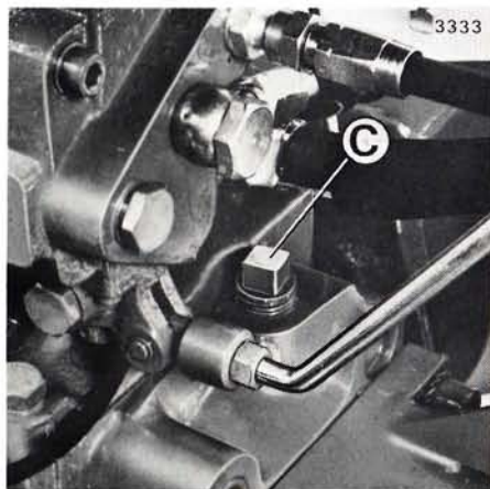
Fig. 25 - Versage et niveau d'huile dans le différentiel arrière
