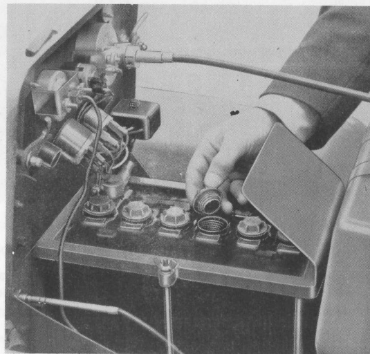
Fig. 23 - Contrôle du niveau de l'électrolyte
